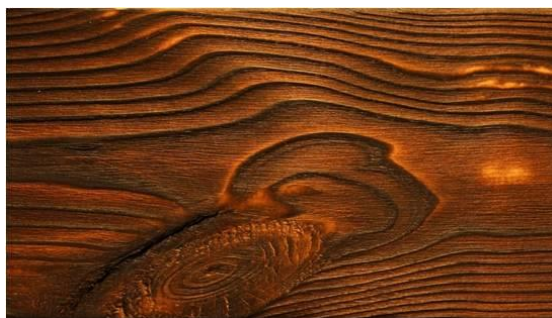
Рис. 1. Фотография поверхности изделия из древесины сосны после обработки потоком плазмы
