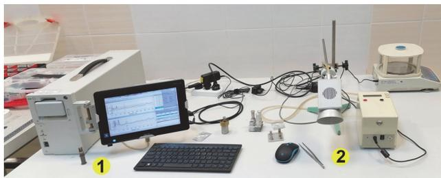
Рис. 1. Хроматограф «ЭХО-В-ИДПС»: 1 – хроматограф; 2 – пробоотборное устройство
