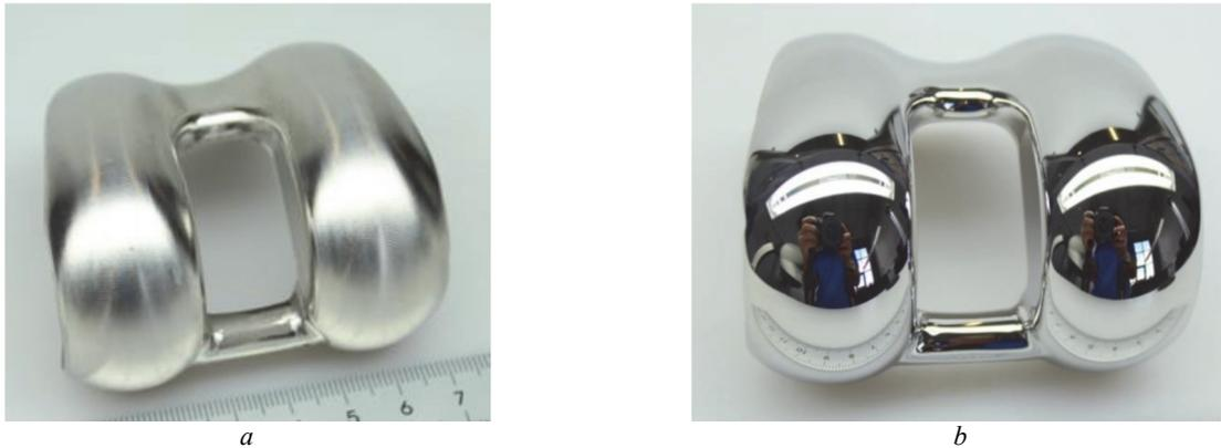
Рис. 1. Внешний вид бедренного компонента эндопротеза коленного сустава из CoCr:
