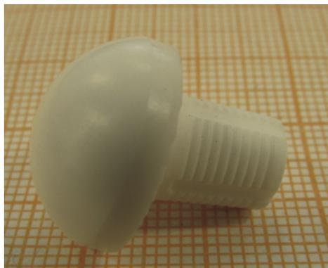
**Рис. 4.** Внешний вид заготовки эндопротеза, прошедшего механическую и абразивно-струйную обработку до галтовки
