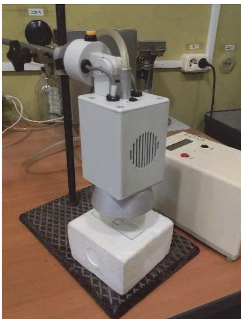
Рис. 7. Отбор пробы воздуха с поверхности предметного стекла
