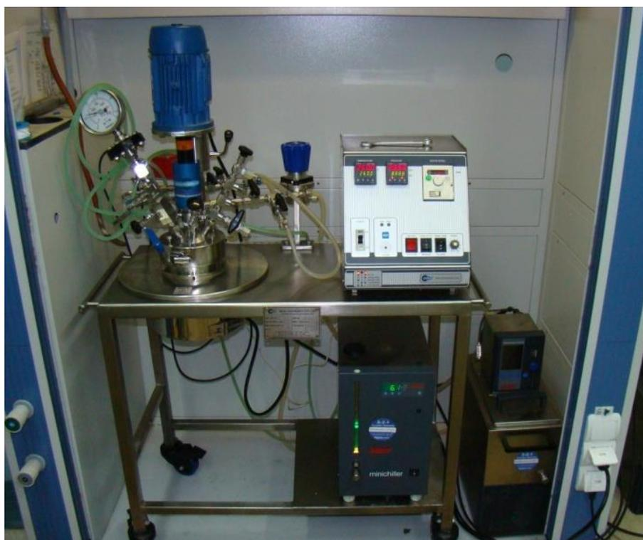
Рис. 2. Лабораторный автоклав для извлечения ценных компонентов из измельченных руд
