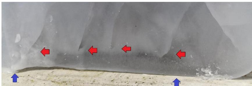
**Рис. 7.** Пример остановки трещин у нагретой поверхности
