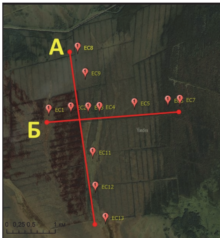
Рис. 2. Схема расположения профилей электропроводности в пределах участка Васюганского болота
