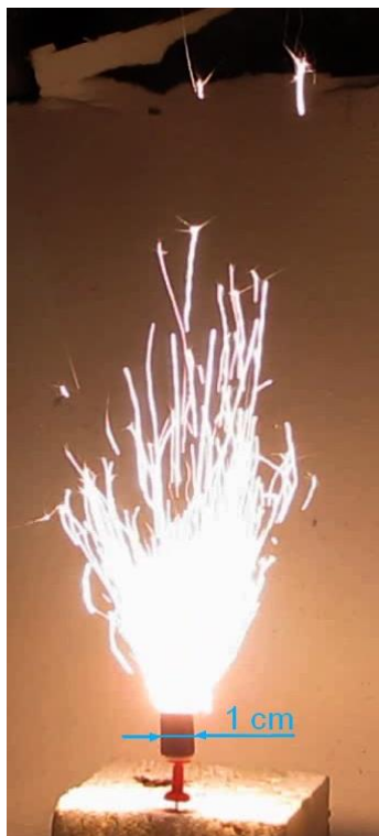
Рис. 6. Горение топлива 555 в комнатных условиях (воздух, 1 атм)
