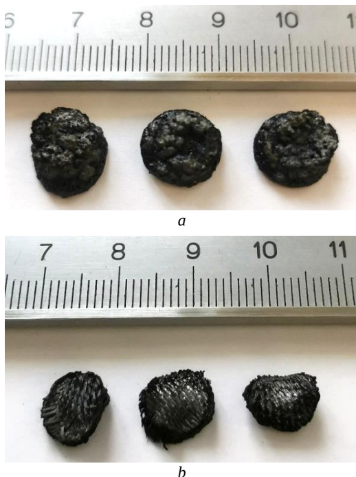
Рис. 5. Фотографии образцов ПКМ (ПК) (a) и ПКМ (ОП) (b) после воздействия лучистого теплового потока Fig. 5. Photos of the samples made of (a) PCM (PC) and (b) PCM (OP) after exposure to a radiant heat flux
