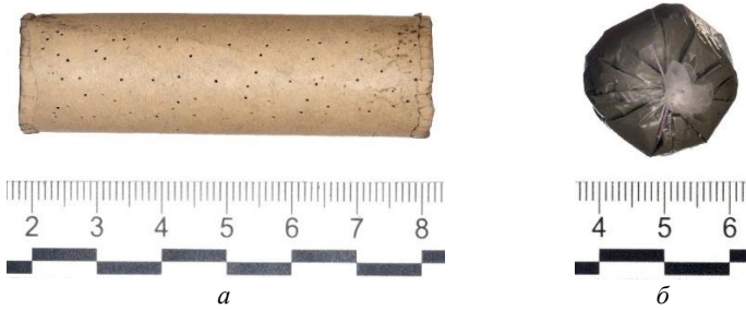
Рис. 3. Внешний вид картузов с традиционным зарядом (а) и модельным высокоплотным топливом (б)
