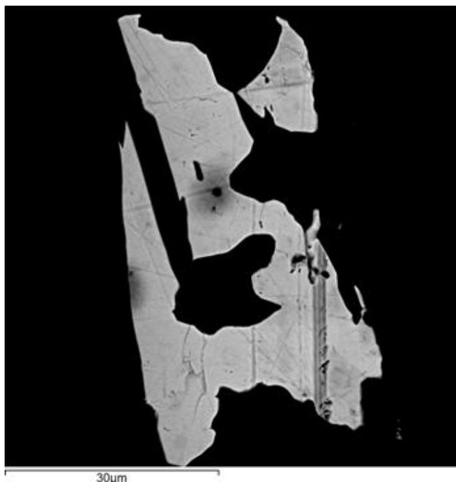
Рис. 3. Изображение в обратно рассеянных электронах частицы, содержащей  $Pd$ ,  $Te$ ,  $Bi$ , в матрице халькопирита, а также в ассоциации с диопсидом
