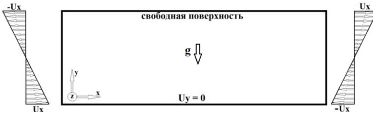
**Рис. 6.** Схема граничных условий для численных экспериментов для слоев земной коры и верхней мантии
