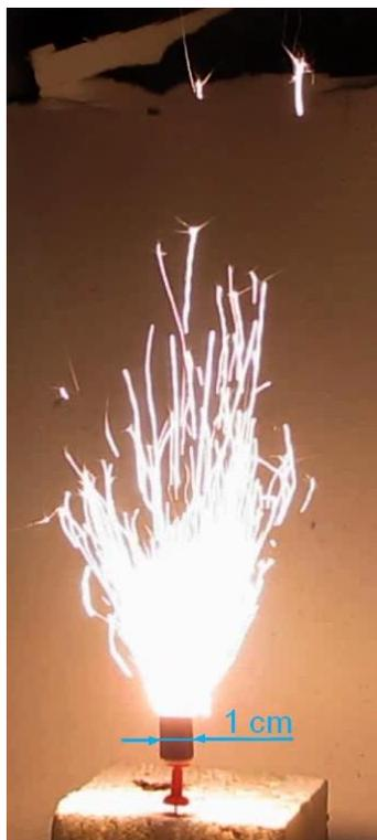
Рис. 6. Горение топлива 555 в комнатных условиях (воздух, 1 атм)
