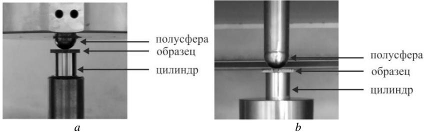
**Рис. 1.** Испытания на изгиб на кольцевой опоре:
