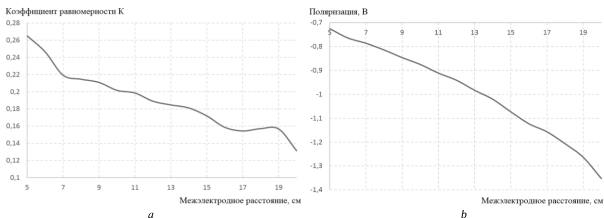
Рис. 3. Зависимости равномерности покрытия (a) и катодной поляризации (b) от межэлектродного расстояния Fig. 3. Dependences of coating uniformity (a) and cathodic polarization (b) on the interelectrode distance
