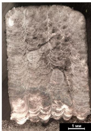
Рис. 9. Макроструктура образцов, полученных по оптимизированным параметрам лазерного выращивания из порошковой смеси Inconel 625 – 5 мас. % Al–TiB 2
