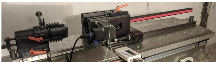
**Рис. 3.** Баллистическая установка
