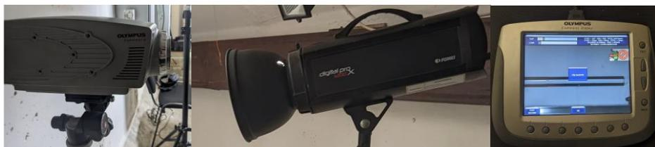
**Рис. 4.** Высокоскоростная камера, прожектор и результаты фиксации положения ствола на экране
