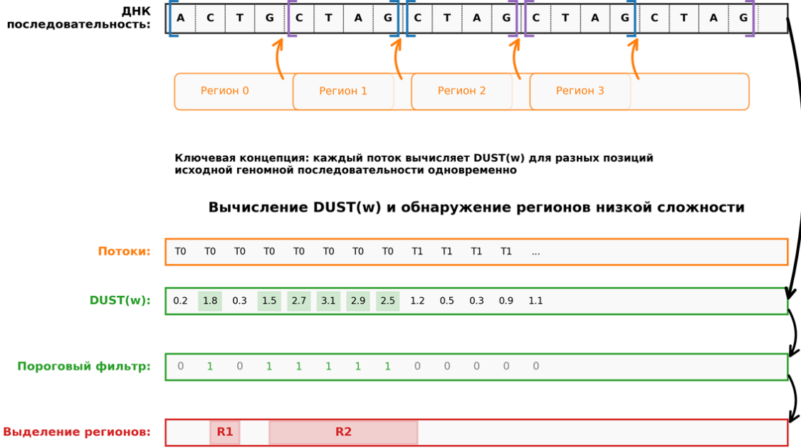
Рис. 1. Концептуальная схема параллельной обработки в DUSTSCAN (R1, R2 – обнаруженные регионы)
