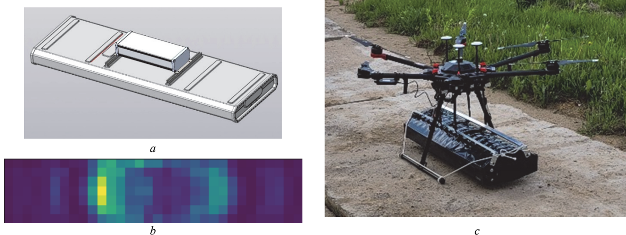
Рис. 10. Трёхмерная модель георадара (а), амплитудная карта зондируемого подповерхностного объекта на глубине 10 см в результате имитационного моделирования (с) и фото расположения георадара на малом БПЛА со взлетной массой до 50 кг (b)
