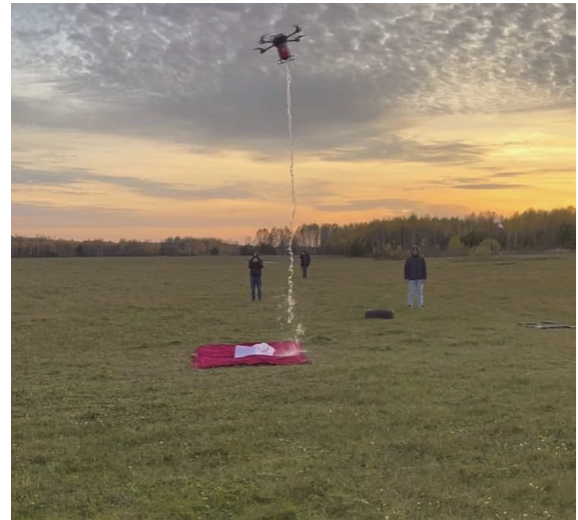
Рис. 7. БПЛА, оснащенный модельным сливным устройством, и процесс сброса жидкости с высоты 10 м
