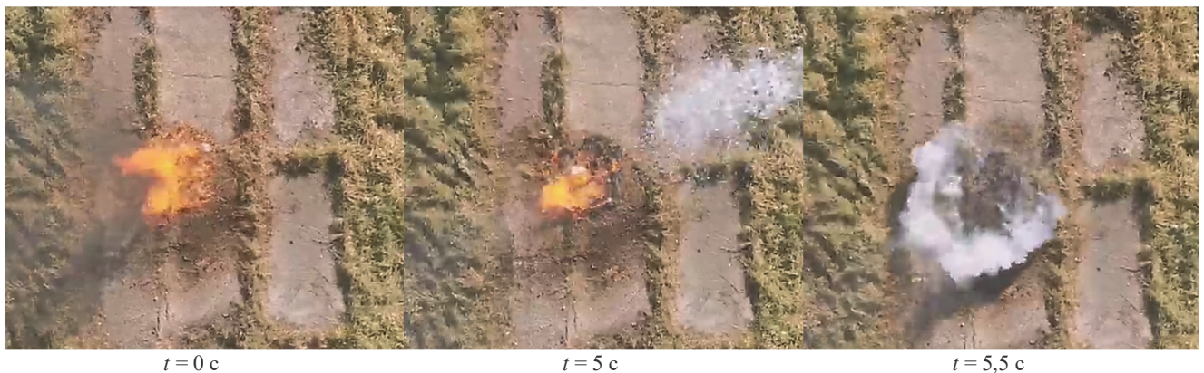
Рис. 9. Видеокадры процесса тушения ограниченного очага пожара при сбросе жидкости с БПЛА ( t – время)
