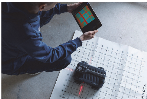
Рис. 1. Определение скрытых объектов с помощью георадара GPR RV-01
