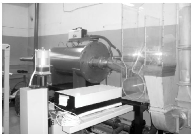
Рис. 2. Экспериментальный стенд по исследованию аэродинамики и процессов смешения в вихревой топке: 1 – модель вихревой топки; 2 – вентиль; 3 – регулятор давления (редуктор); 4 – манометр; 5 – ресивер (для сглаживания пульсаций давления); 6 – дымогенератор XLINE FOG 800; 7 – автоматизированный измерительный комплекс ЛАД-05
