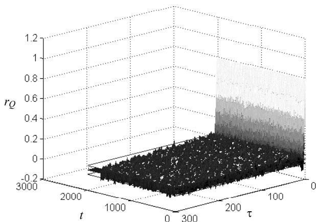
Рис. 9. Нормированная автокорреляционная функция остатков и границы 95 %-го интервала её незначимости
