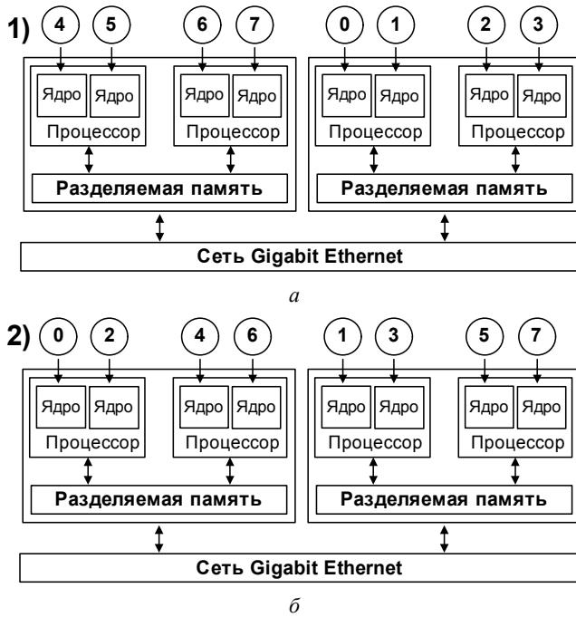
Рис. 2. Реализация ТЦО алгоритмом Дж. Брука на кластерной ВС ( $n = 8$ ;  $m = 2048$ ;  $L = 2$ ): *а* – реализация ТЦО с распределением ветвей стандартным алгоритмом библиотеки MPI; *б* – реализация ТЦО с учетом иерархической организации ВС
