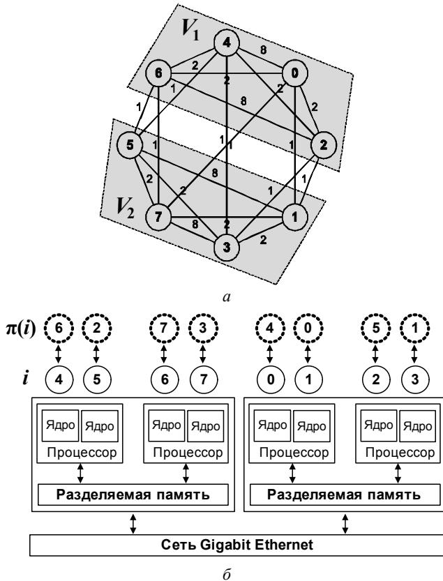
Рис. 3. Пример оптимизации алгоритма Дж. Брука ( $L = 2$ ;  $n = 8$ ;  $h = 2$ ;  $s_1 = 4$ ;  $s_2 = 4$ ):  $a$  – приближенное разбиение графа алгоритма Дж. Брука на подмножества  $V_1$  и  $V_2$ ;  $b$  – отображение  $\pi(i)$  номеров ветвей программы
