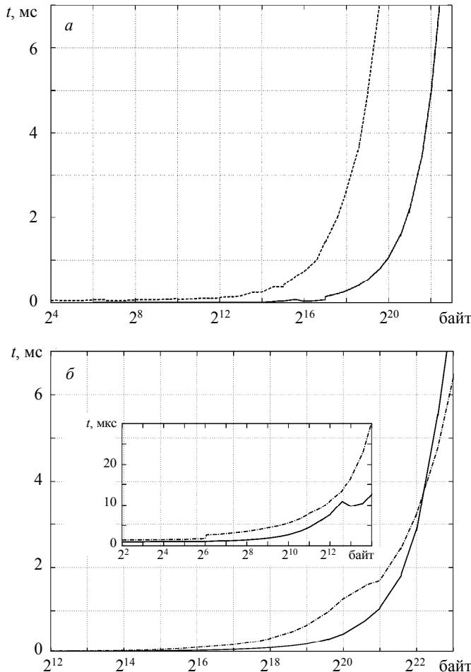
Рис. 1. Время передачи данных между элементарными машинами кластерной ВС через общую память вычислительного узла и сеть межузловых связей: *а* – кластер ЦПВТ ГОУ ВПО «СибГУТИ»; *б* – кластер ИВЦ ГОУ ВПО «НГУ»; — разделемая память; - - - сеть Gigabit Ethernet; - · - сеть InfiniBand 4x DDR
