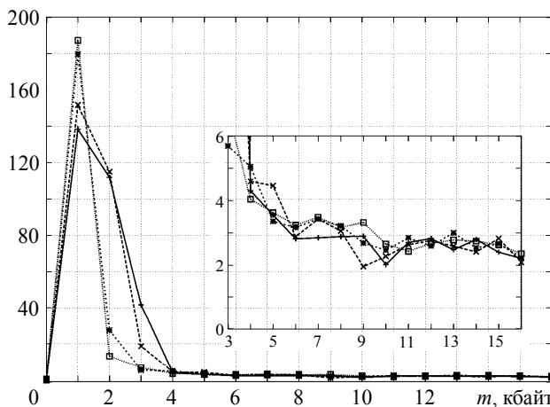
Рис. 6. Зависимость коэффициента ускорения алгоритмов ТЦО от размера  $m$  передаваемого сообщения на кластерной ВС ЦПВТ ГОУ ВПО «СибГУТИ» ( $n = 64$ ;  $h = 8$ ;  $s_1 = s_2 = \dots = s_8 = 8$ ): *a* – ускорение алгоритмов на коротких сообщениях; *б* – ускорение алгоритмов на длинных сообщениях; —+— — алгоритм Bruck exch.; -----\*--- — алгоритм Bruck reorder; .....\*.... — алгоритм recursive doubling exch.; .....■.... — алгоритма recursive doubling reorder
