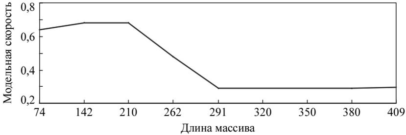
Рис. 10. Изменение модельной скорости волны в среде алюминий – эбонит
