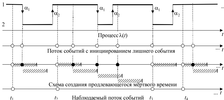
Рис. 1. Формирование наблюдаемого потока событий в схеме с продлевающимся мертвым временем: 1, 2 — состояния случайного процесса \lambda(t) ; штриховка — периоды мертвого времени; t_1, t_2, \dots — моменты наступления событий в наблюдаемом потоке
