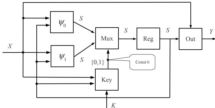
Рис. 1. Структура перестраиваемого автомата
