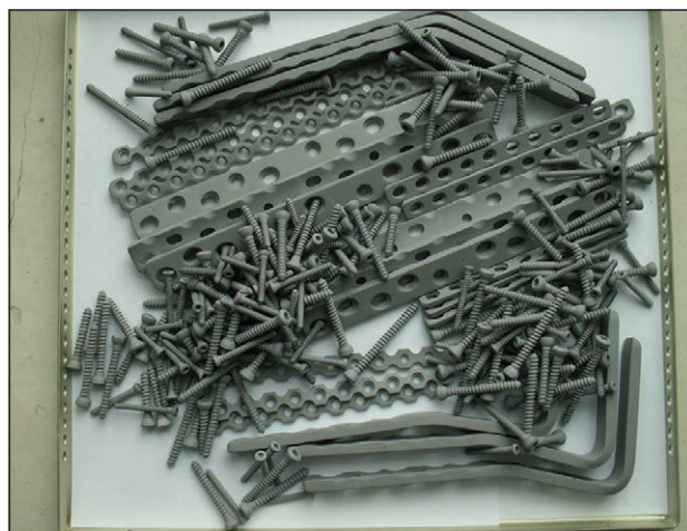
Рис. 1. Титановые имплантаты с биоактивным плотным рентгеноаморфным покрытием
