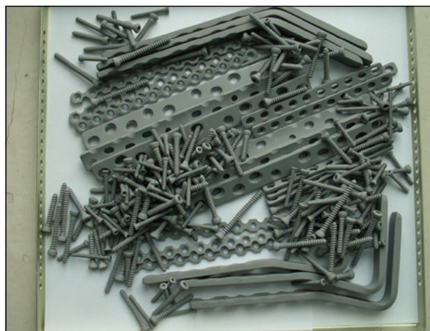
Рис. 1. Титановые имплантаты с биоактивным плотным рентгеноаморфным покрытием
