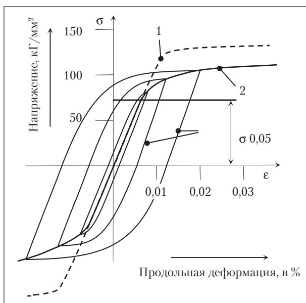
Рис. 17. Монотонная и циклическая диаграммы для титанового сплава ВТ6: 1 — монотонная диаграмма, 2 — циклическая диаграмма, 3 — стабильные петли гистерезиса для разных амплитуд нагрузки, \sigma_{0,05} — циклический предел упругости
