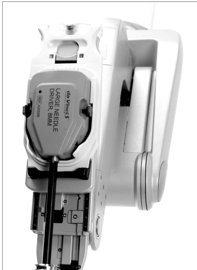
Рис. 5. Система крепления инструментов
