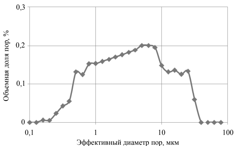
Рис. 6. Зависимость объемной доли пор от эффективного диаметра пор
