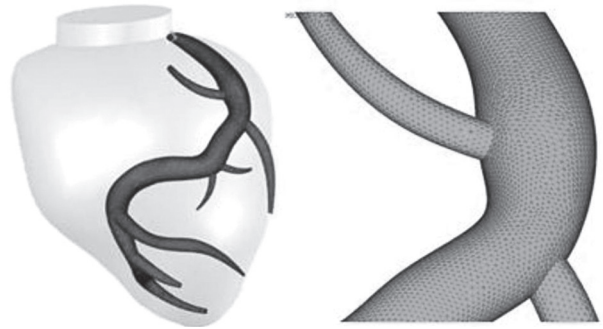
Рис. 5. Наложение расчетной сетки на модель ПВА
