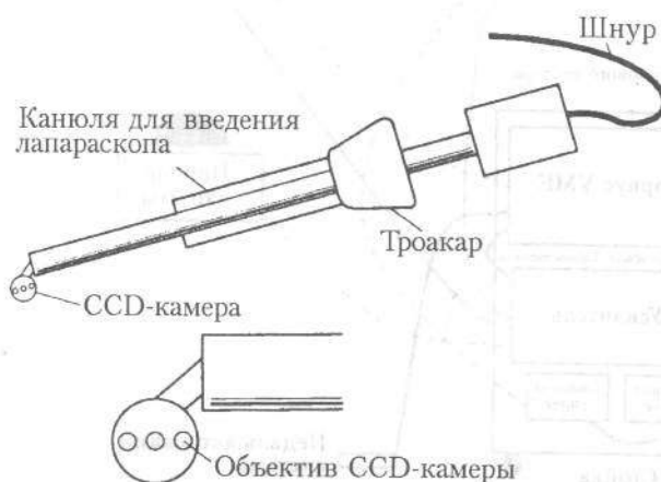
Рис. 4. Лапароскопическая видеокамера с обзором на 360° (схема)
