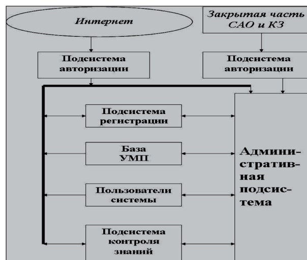
Рис. 3. Структурная схема системы «Гамаюн-Инфо»
