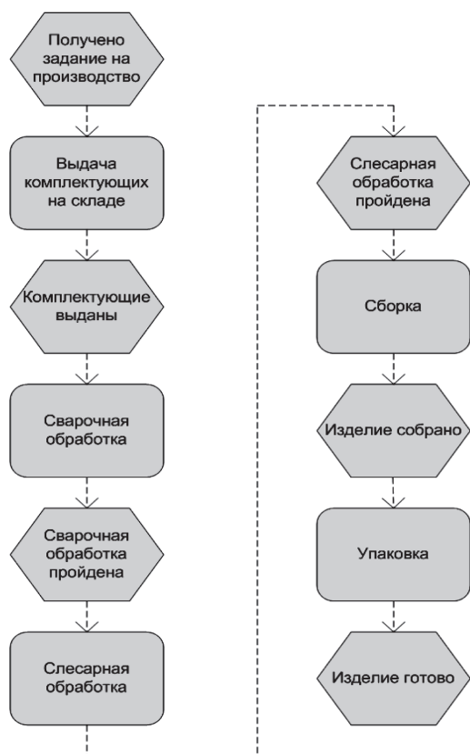
Рис. 2. Структура процесса при его выполнении в производственном отделе
