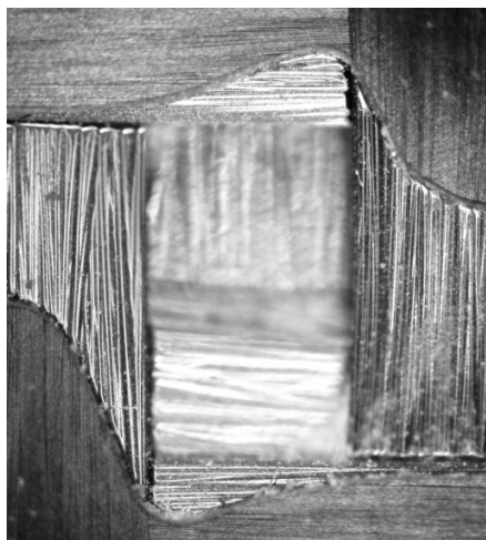
Рис. 1. Образование пор в ламинате при дефектах оснастки
