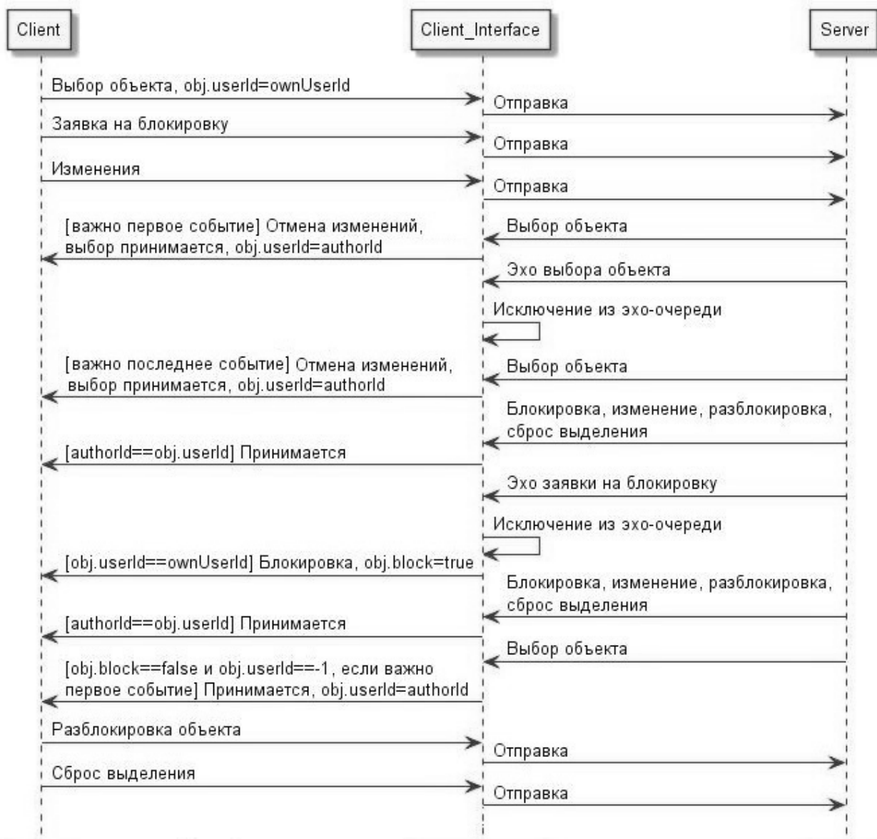
Рис. 3. Обработка событий блокирования и разблокирования ресурса клиентом – автором событий: ownUserId – идентификатор пользователя клиентского приложения. На рисунке опущено возвращение эха разблокировки объекта и добавление собственных событий в эхо-очередь
