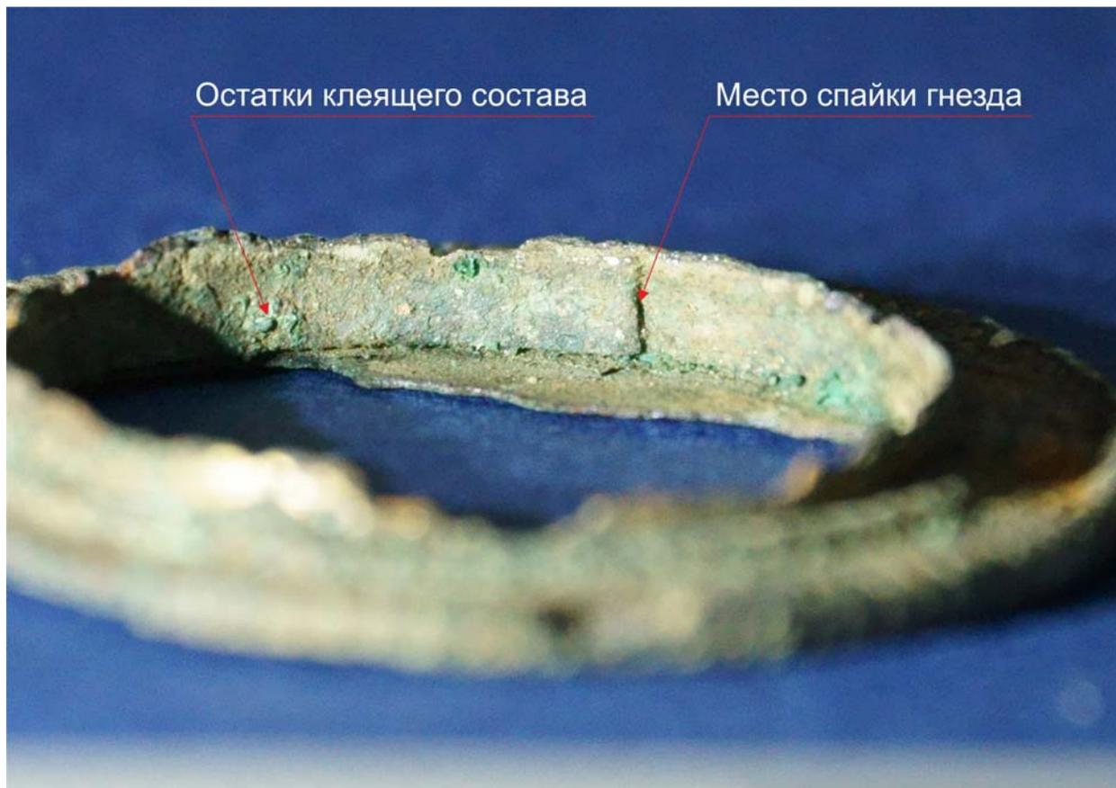
Рис. 5. Место спайки гнезда и остатки клеящего состава на изделии № 3
