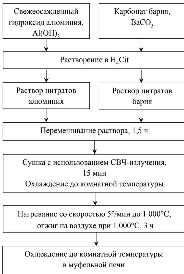
Рис. 1. Схема синтеза  $BaAl_2O_4$
