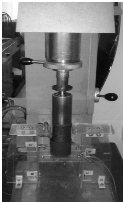
Рис. 1. Экспериментальные коллоидно-химические ячейки для снятия спайковых выстрелов тока самоорганизации оксигидратных гелей с вращающимся графитовым электродом
