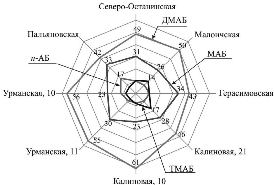
Рис. 3. Содержание n -АБ, МАБ, ДМАБ и ТМАБ в алкилбензолах исследованных нефтей
