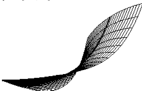
Рис. 4. Лепесток сетеполотна, искривленный вследствие «матрасного эффекта». Видна срединная (гребневая) линия
