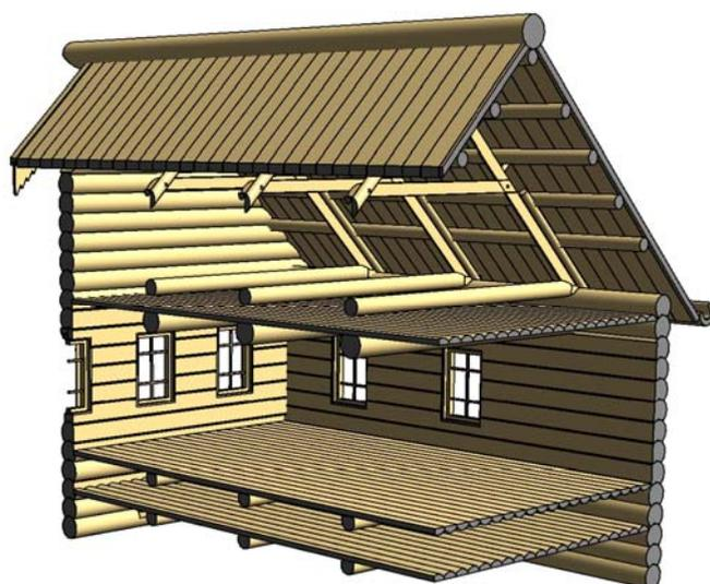
Экспериментальная информационная модель избы. Объемный разрез
