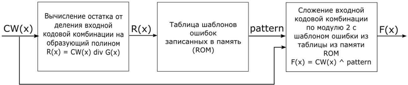
Рис. 2. Структурная схема реализации табличного метода декодирования
