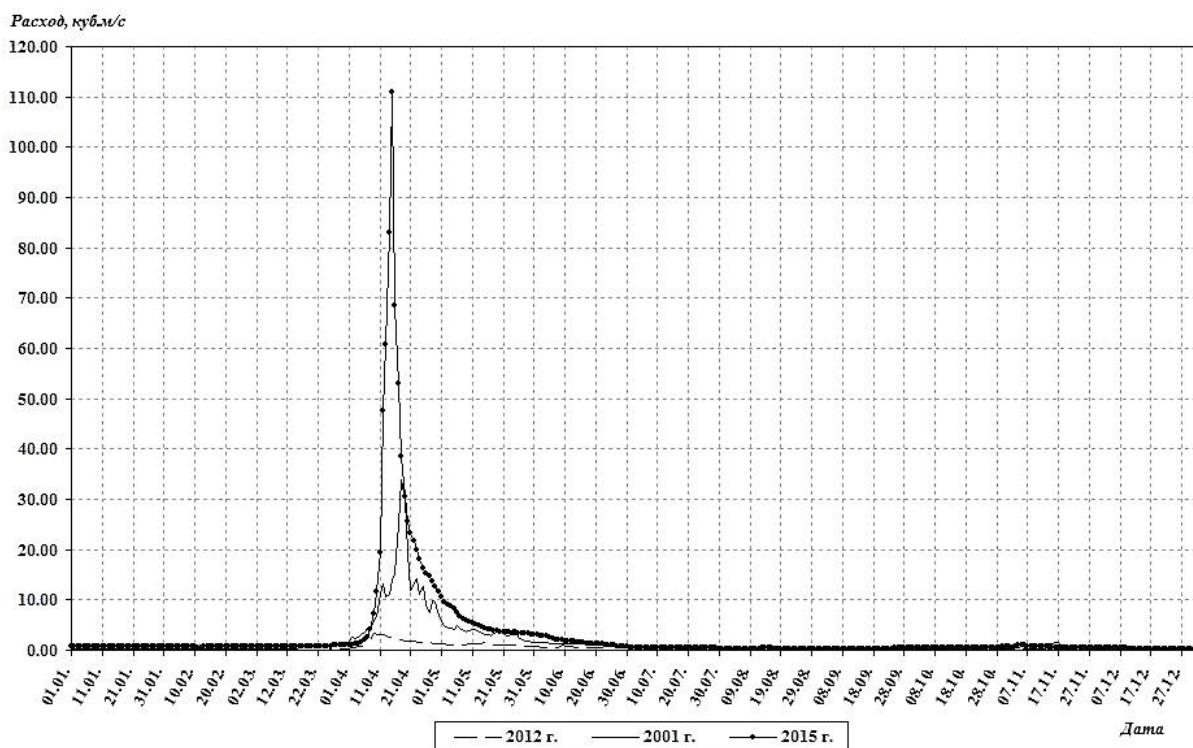
**Рис. 3. Гидрографы р. Касмала за характерные годы в период 1998–2017 гг.:
