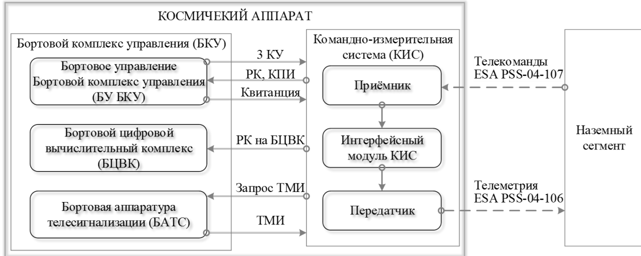
Рис. 1 Схема командно-телеметрического взаимодействия систем Fig. 1. Scheme of command-telemetric interaction of systems
