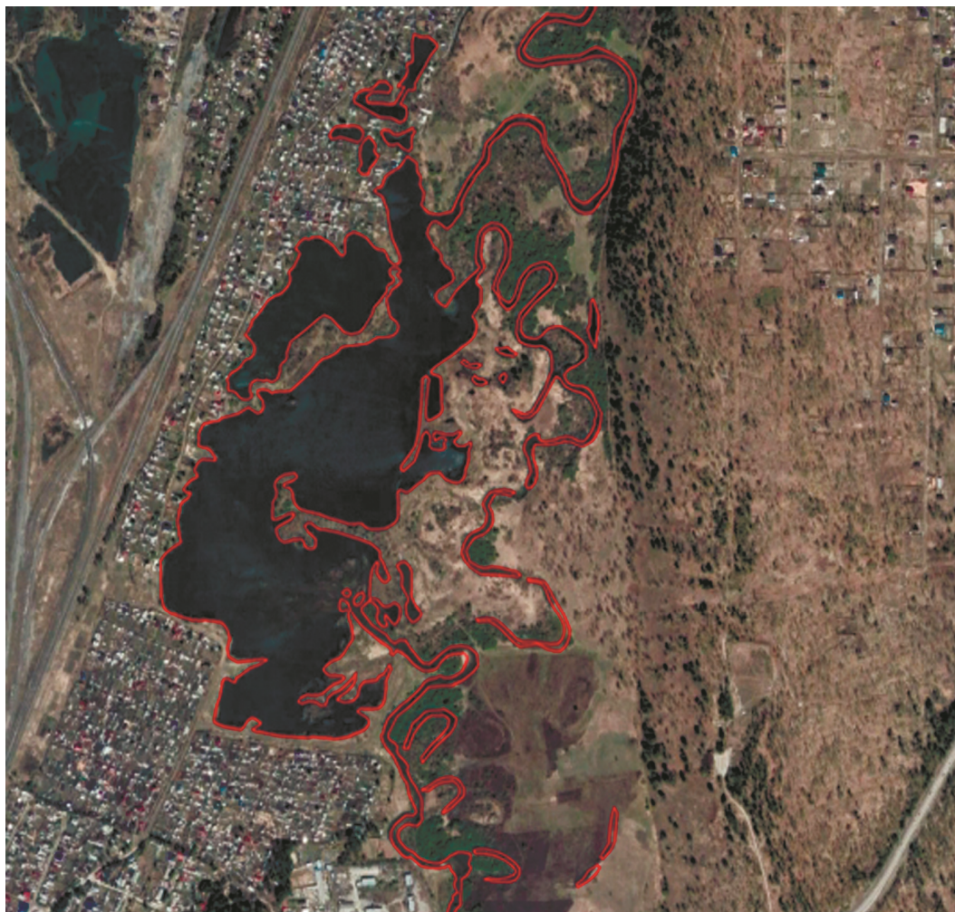
Рис. 4. Русловые деформации р. Олха на участке озеровидного расширения
