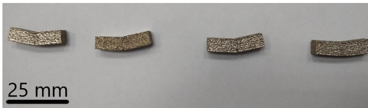
Рис. 3. Внешний вид образцов после испытаний на изгиб Fig. 3. Appearance of specimens after bending tests
