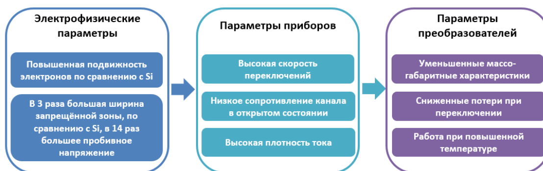
Рис. 1. Преимущества GaN-приборов перед кремниевыми аналогами на электрофизическом, приборном и системном уровнях
