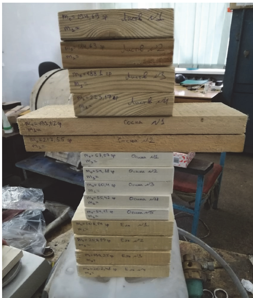
Рис. 3. Исследуемые образцы: осина, лиственница, сосна, ель
