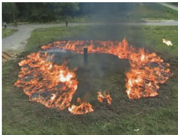
Рис. 5. Испытания АСП-500 на функционирование и эффективность тушения низового пожара
