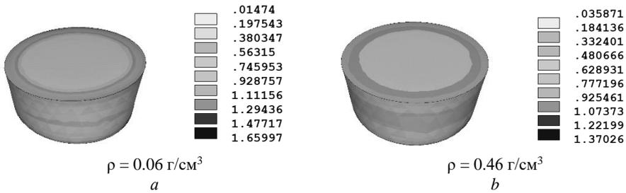
**Рис. 3.** Распределение напряжений по Мизесу  $\sigma_{eqv}$  (МПа) в эндопротезе с размерами  $D = 12$  мм,  $H = 6$  мм при наклоне вперед сегмента с плотностью губчатой костной ткани позвонков  $0.06$  г/см<sup>3</sup> (a) и  $0.46$  г/см<sup>3</sup> (b) (вид сверху и спереди)
