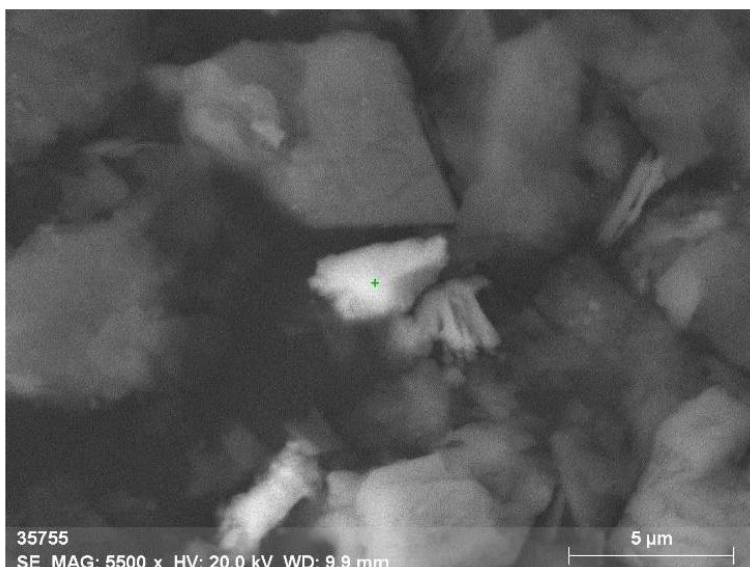
Рис.3. Микрофотография углисто-глинистых сланцев, отмечена фаза сульфида меди и железа (халькопирит)
