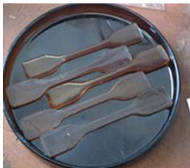
Рис. 8. Образцы второй группы, отвержденные заранее, перед гамма-облучением
