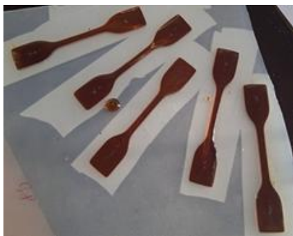
Рис. 7. Образцы первой группы после отверждения под действием гамма-облучения
